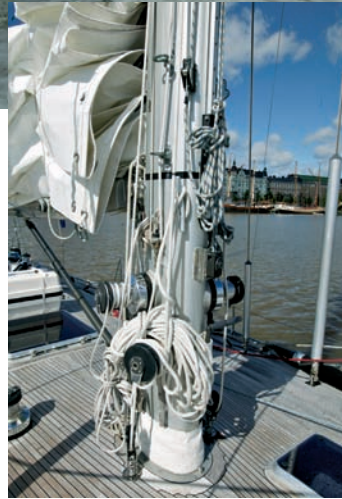
Blue Magicissa on neljä vinssiä ja kahdeksan vapautinta mastolla. Näin nostin- ja reiviköyksiä ei kerääny veneen kannelle tai avotilaan. Isopurjeen mastoliesmassa on Harkenin kuulalaakeroidut vauvut, joten raskas purje nousee suhteellisen kevyesti mastoon.
