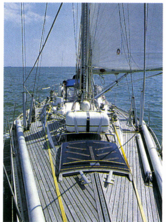
La section des tangons laisse imaginer les efforts pour envoyer le spi de 173 m 2 .
