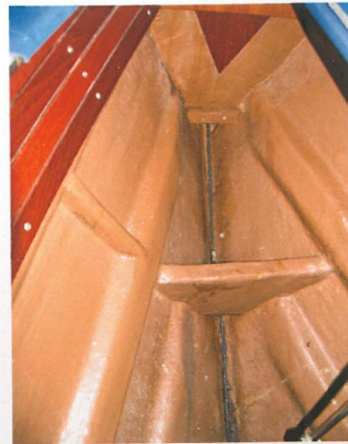
Eine grundsätzliche Konstruktion. Der Rumpf ist über ein enges System aus Stringern und Schotten versteift
