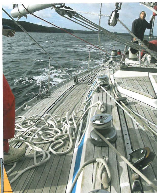
Jede Leine hat eine eigene Winsch. Heute sorgen Hebelklemmen für mehr Platz an Deck
