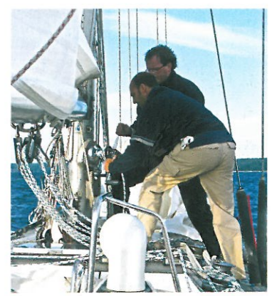
Die Fallen werden am Mast bedient, entsprechende Winschen sind auf dem Aufbaudeck platziert
