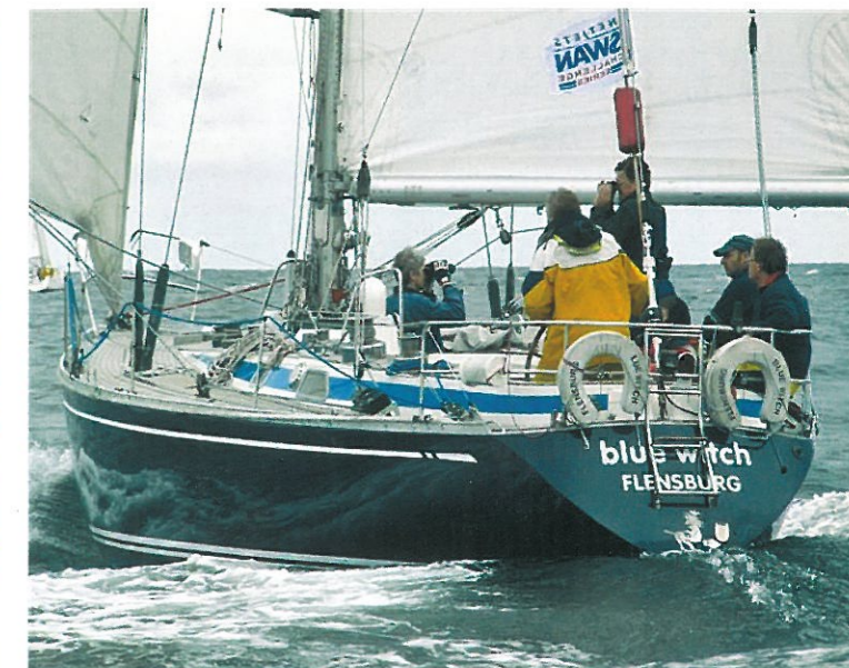
Aufgrund des schlechten Zugwinkels sind Großschot und Traveller kraftraubend zu bedienen
