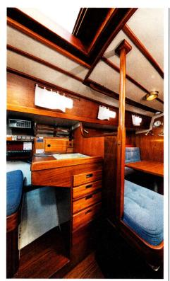
**VERSTÄRKT**Halbschotten und Decksstützen steifen die Rumpfschale aus dem damals neuartigen Werkstoff GFK aus
