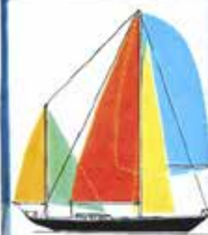
ANDATURA PORTANTE; VENTO MEDIO (FORZA 5/6). Il più robusto starcut (azzurro) sostituisce il grande « spi »; la carbonera (verde) è più pesante e il tallboy (giallo) rimpiazza il bolero.
