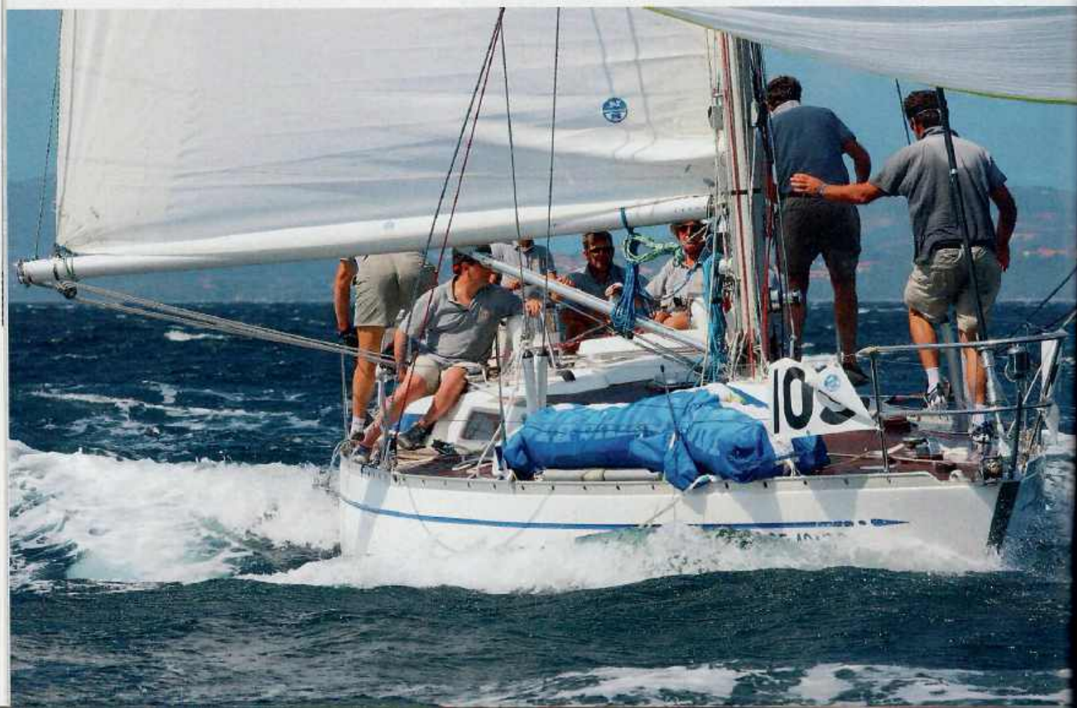
Die markanten Deckslüfter sowie die vielen Winschen, die an Deck stehen, sind Merkmale der Swans von Sparkman & Stephens. Es sind durchdachte Details, gebaut für raue See.
